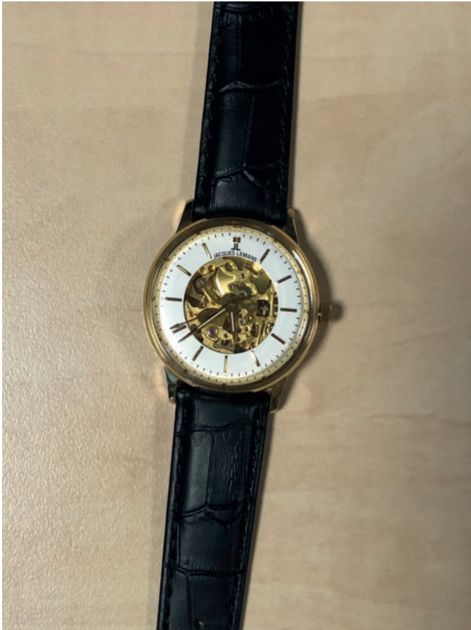
Skelettierte Uhrwerke, sogenannte Sekelettuhren, ermöglichen einen Einblick in das Uhrwerk. Durch Stanzen, Sägen oder Fräsen wird das Uhrwerk soweit reduziert, dass Aussparungen entstehen, die den Blick in das Uhrinnere freigeben.
