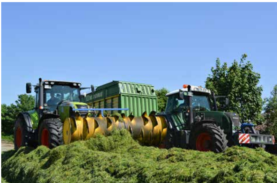
Ladewagen bringen das Gras vom Feld in den Fahr-silo (rechtes Fahrzeug). Dort wird es mit schweren Schleppern gleichmäßig verteilt und verdichtet (linkes Fahrzeug).
